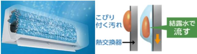
冷房運転で発生させた結露水を利用して熱交換機の汚れを洗浄。結露水で洗浄後にストリーマ照射（プラズマ放電の一種で有害化学物質を分解）と乾燥運転を行い、熱交換器をきれいにします。
